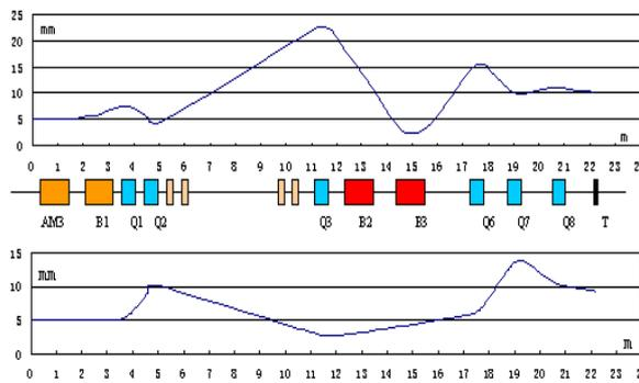
图 3 E2 束流线结构和束流包络
