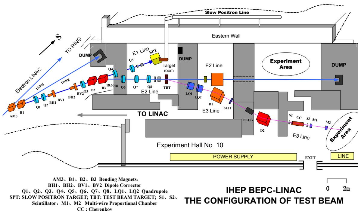
图 1 实验厅的屏蔽结构和束流线布置示意图
