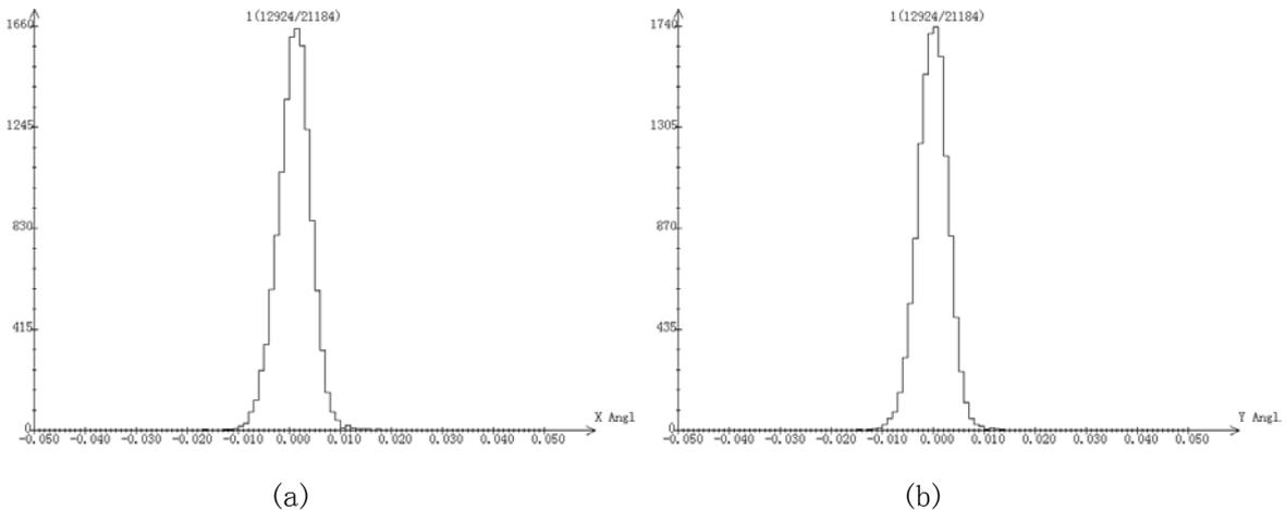
图 7 粒子方向角分布 (030610 数据) (a) 水平方向角分布, (b) 垂直方向角分布
