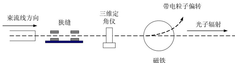
图 4 辐射实验研究基础装备示意图
