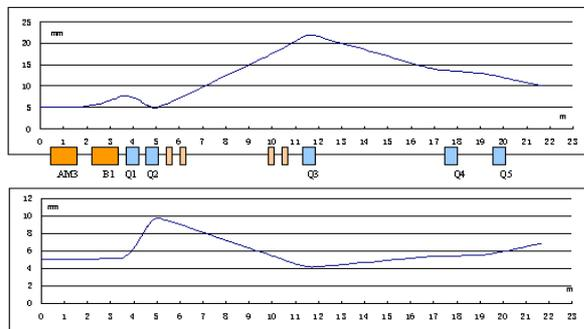
图 2 E1 初级束线结构和束流包络
