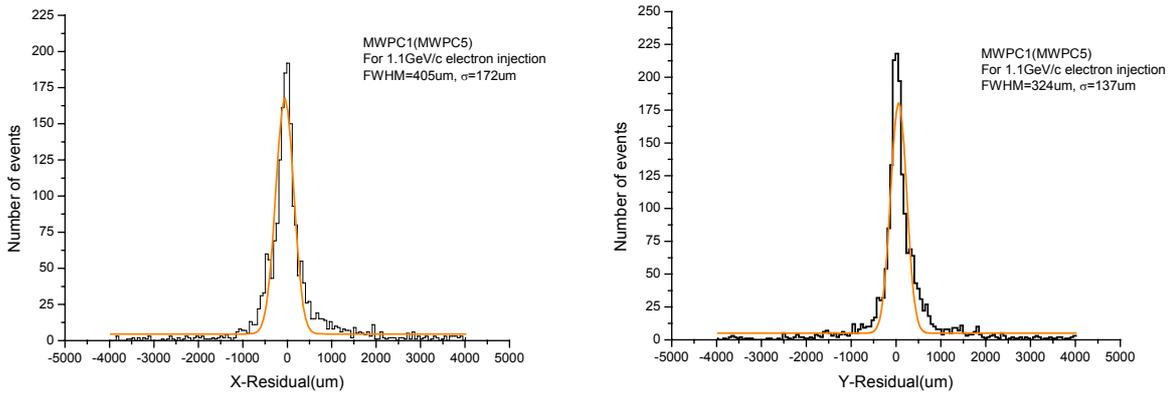
图 6 MWPC1 X 和 Y 方向残差分布
